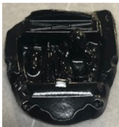
Piloto de lexan errado: Com a extensão lateral, mas sem pintura.
