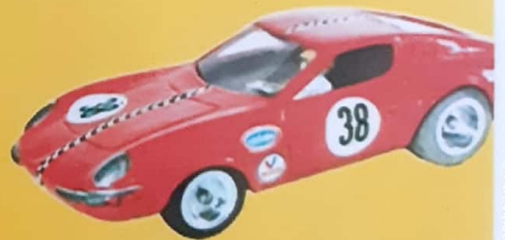
N. 95508 - Carro 1:32, Puma 1600 GT, injetado, chassis de aluminio monobloco, n.º 98206.
